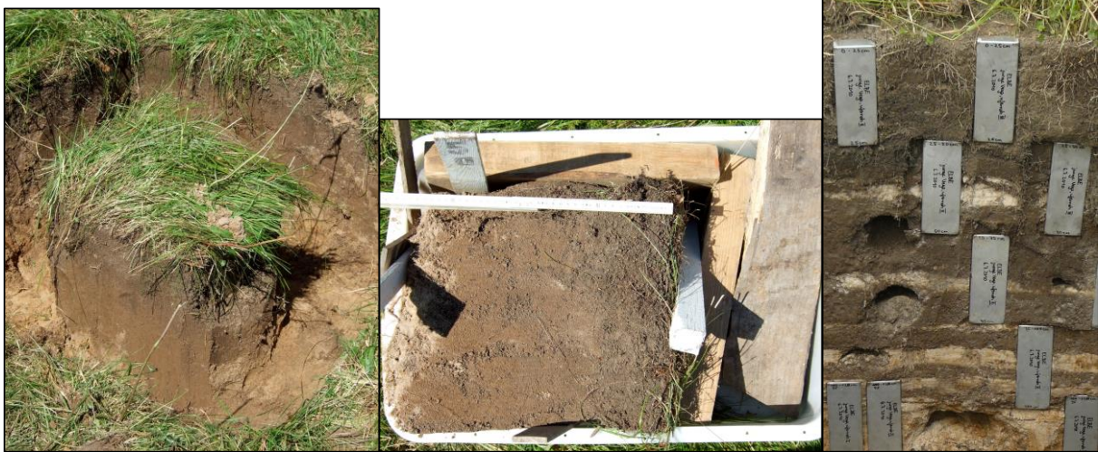
Abbildung 51: Unterschiedliche Probennahmetechniken zur Ermittlung der feinstratigrafischen Belastung unter Wahrung der natürlichen Lagerungsdichte (Fotos Krüger).
