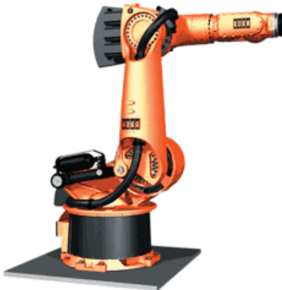
Mechanik mit 500 kg Traglast (Werkbild KUKA)
