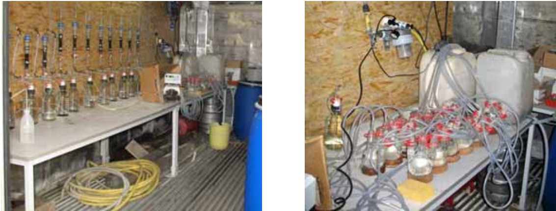
Abb. 10-2: Aufbau der Säulenversuche (links) und der Probenahmekolben für die vor-Ort-Parameter (rechts) im vor-Ort-Container am Standort Lünen. Zulaufwasser entstammt der GWM 12Q.
