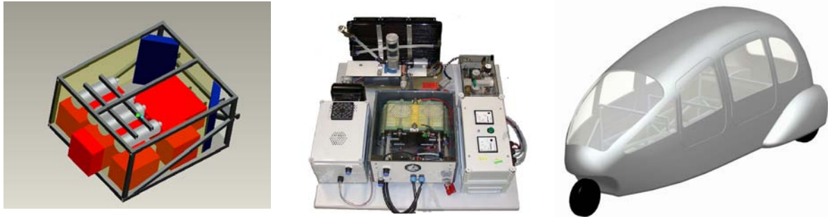
Bild 23: Zukünftige Entwicklungen am „eLTeC FCX“: Brennstoffzelle als Range Extender und GFK-Karosserie
