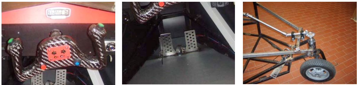
Bild 22: Konstruktive Leichtbaumaßnahmen am eLTeC FCX
