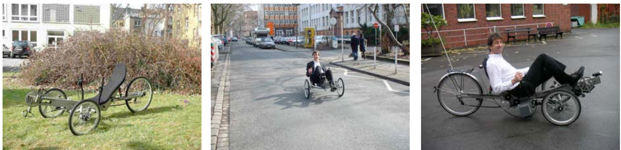
Bild 13: Das eLTeC MP – ein Liegedreirad mit Elektro-Hilfsmotor
