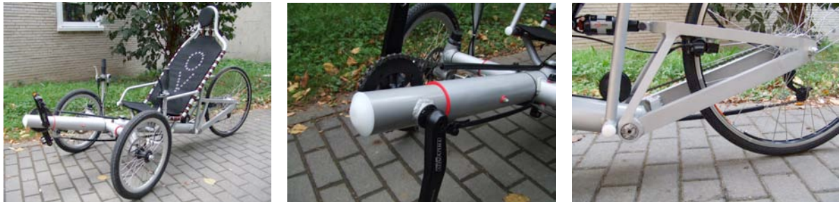
Bild 18: Das eLTeC OV – ein Liegedreirad aus Aluminium
