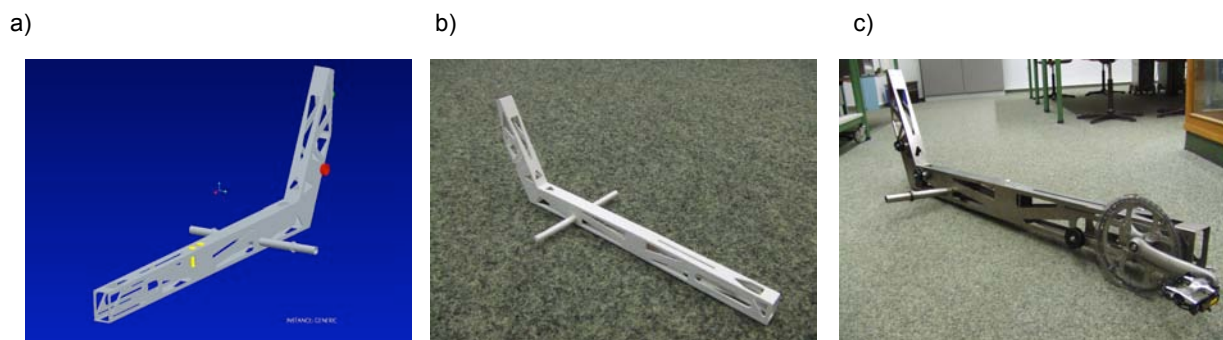
Bild 17: a) CAD-Modell, b) Rapid-Prototyping-Modell und c) Prototyp des optimierten eLTec MP - Rahmens
