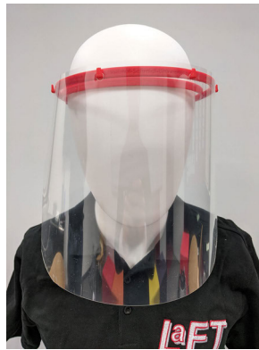
Abb. 145/146: Maker:innen im Kampf gegen Covid. Links: Modelle für 3D-gedruckte Türöffner zum Download auf der Plattform Thingiverse. Rechts: 3D-gedruckte Halterung für Gesichtsschutz des Open Lab Hamburg.
