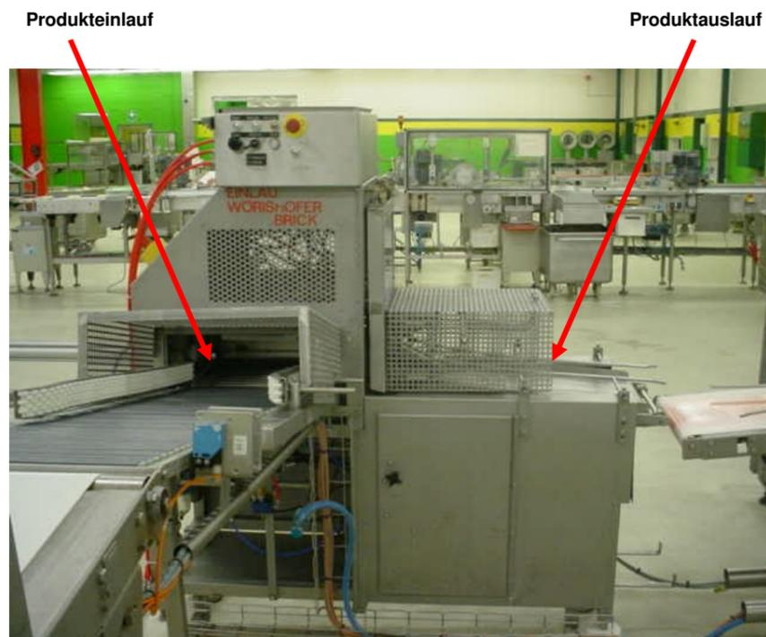
Abb. 4.7: Produktein- und auslauf des Beutelfüllgerätes
