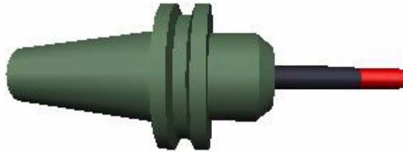
ABBILDUNG 6. Kugelkopffräser mit Aufnahme aus der Simulation 'CNC Milling' Quelle: STA GmbH
