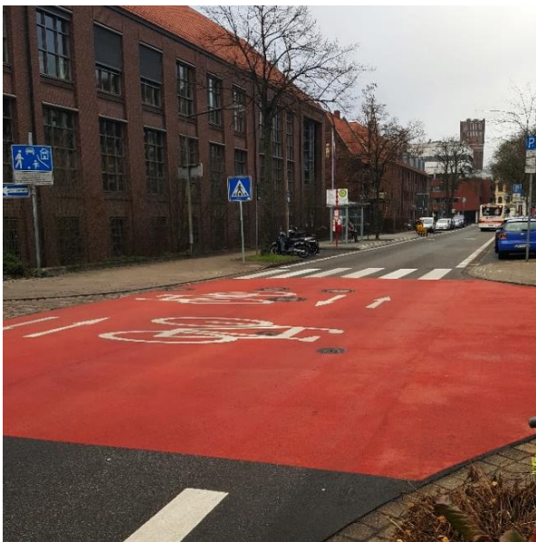
Abb. 15 Piktogramme und Einfärbung (Zwischenknotenpunkt Wallstraße/Gummastraße/An den Reeperbahnen). Foto: eigene Aufnahme.
