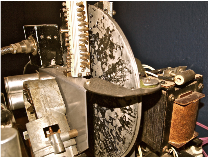
Abb. 8: Detailaufnahme der Lochscheiben mit Lichtmatrix
