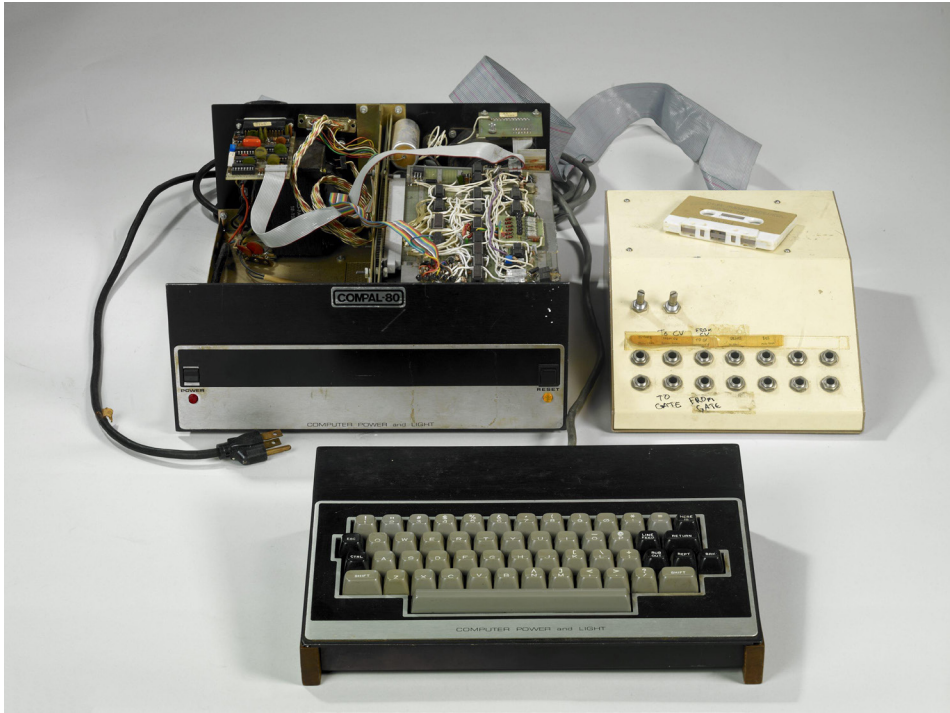
Abb. 41: Roger Linns erster Drum-Machine Prototyp, bestehend aus dem Compal-80 Heimcomputer und einem Roland-Soundboard (im beige Gehäuse).
