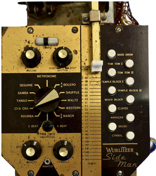
Abb. 11: Das Bedienfeld des Wurlitzer Sideman
