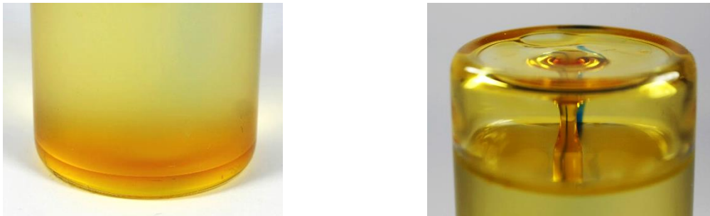
Abbildung 76: Bildung hochmolekularer Oxidationsprodukte am Gefäßboden nach einem Tag
