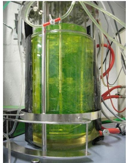
**Abb. 4-7:** Verteilung von Uranin im Reaktor, unmittelbar nach Zugabe
