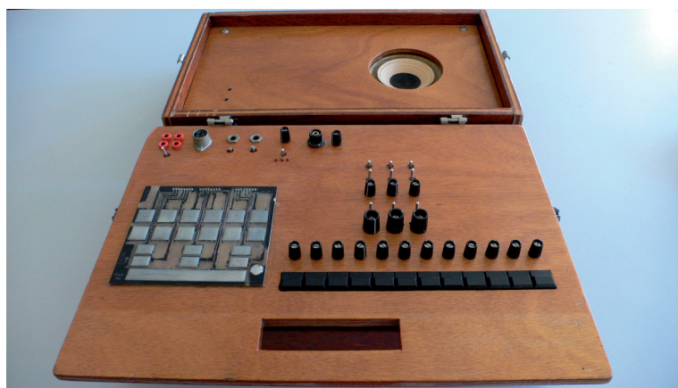
Abb. 4.11 Die linke Seite des Cracklesynths besteht aus drei kombinierten Crackleboxes zur Klangmodulation, mit den Schaltern können tonale Skalen gespielt werden.
