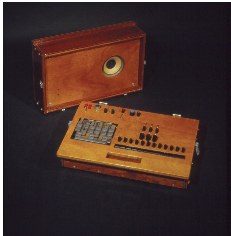
Abb. 4.9 Der Lautsprecher dient gleichzeitig als Deckel des Koffers
