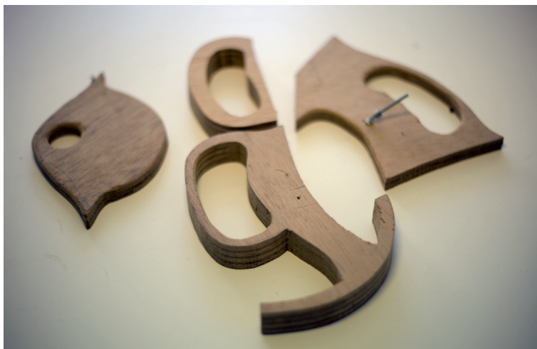
Abb. 5.17 Die Entwürfe für die hölzernen Rahmen der rechten Hand des MIDI-Conductors hatte Waisvisz selbst angefertigt. Dieses Design war formgebend für die zweite Version von The Hands ab 1990.
