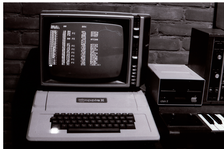
Abb.7.5 Der Apple II Computer wurde am STEIM in den 1980er Jahren mit eigener Software für musikalische Zwecke eingesetzt.
