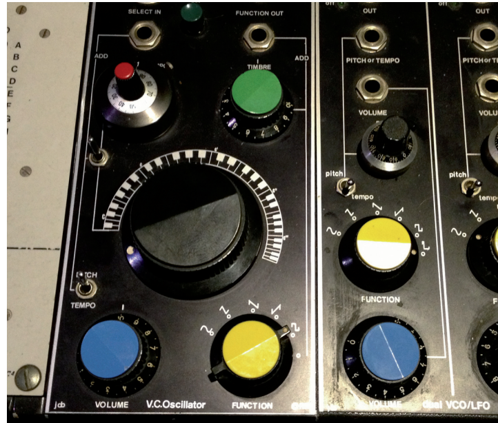
Abb. 3.3. Oszillator-Module des Black Box Systems, ein Keyboard auf dem Drehregler repräsentiert die Tonhöhen.
