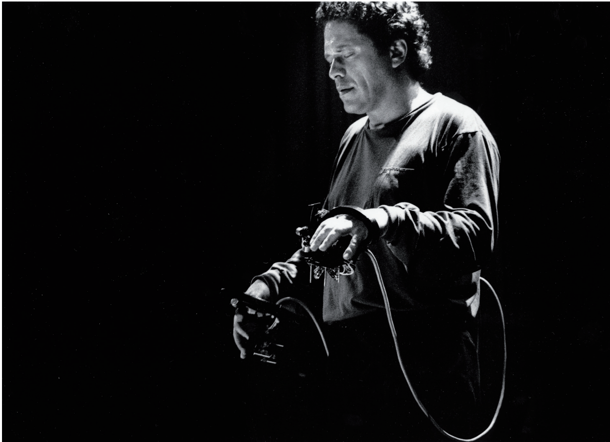
Abb. 5.20 Die Version 2 von The Hands ermöglichte mit Holzrahmen eine besser an die Hand angepasste Spieltechnik. Zur Digitalisierung der Hand- und Armgesten wurde das nun serienreife SensorLab eingesetzt.
