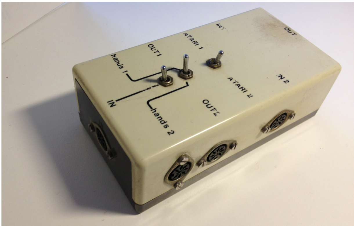
Abb. 5.13 Switchbox für The Hands v1, mit der auf ein zweites System aus The Hands und Atari-Rechner als Backup während der Performance gewechselt werden konnte.
