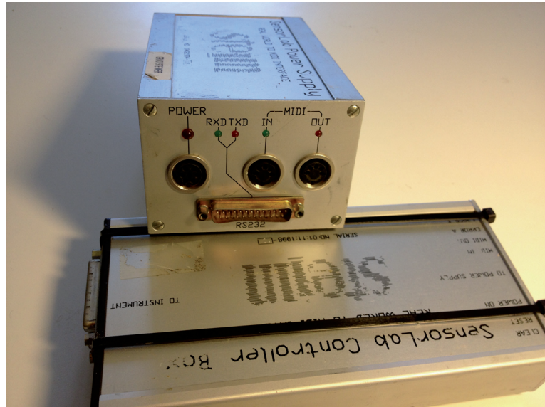
Abb. 6.16 SensorLab Controllerbox (unten) mit Powersupply, der das am Körper tragbare Gerät mit Strom versorgt und die RS232- und MIDI-Anschlüsse bereitstellt (1993).
