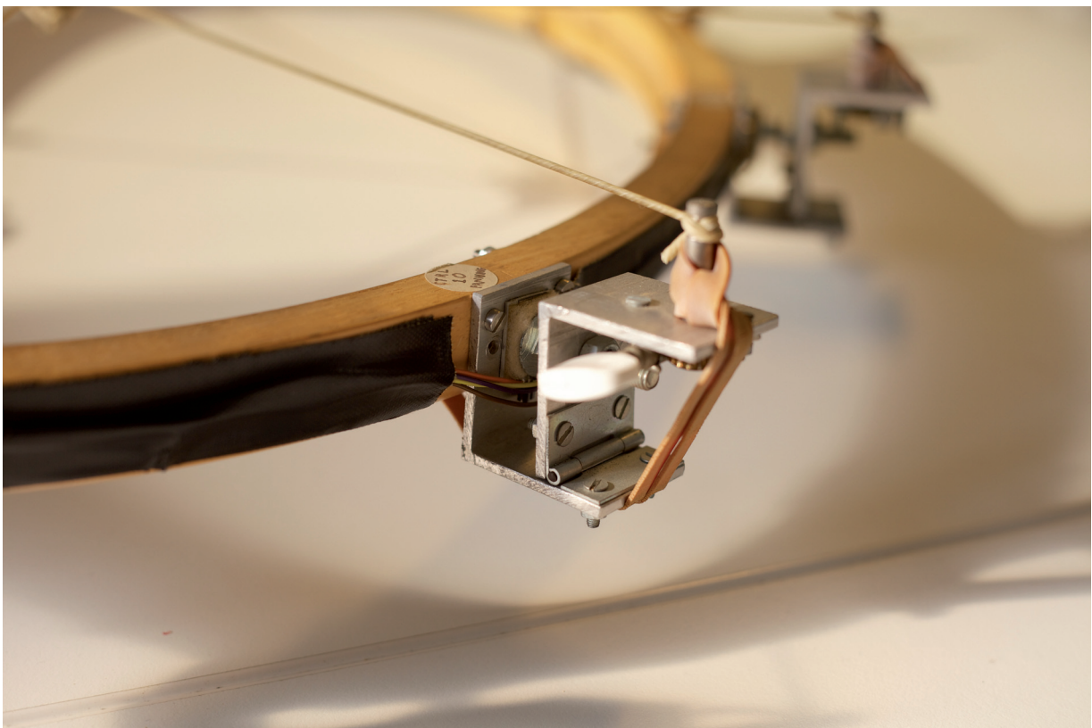
Abb. 6.20 Detail der Sensorik, die zunächst über Druckmessung realisiert wurde.
