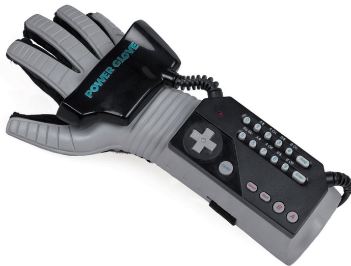
Abb. 6.25 Die Daten des Nintendo Power Glove wurden von Mark Trayle am STEIM mit dem SensorLab ausgelesen. Die meisten Datenhandschuh-Projekte am STEIM der 1990er Jahre zielten jedoch auf eigene Hardwarelösungen.
