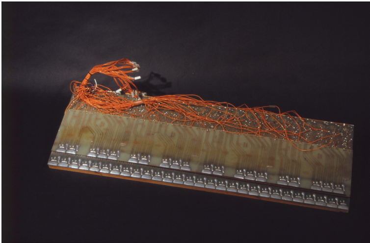
Abb. 4.13 Innenleben der Crackle-Organ. Die Platine ist in der Waisvisz-Sammlung erhalten.
