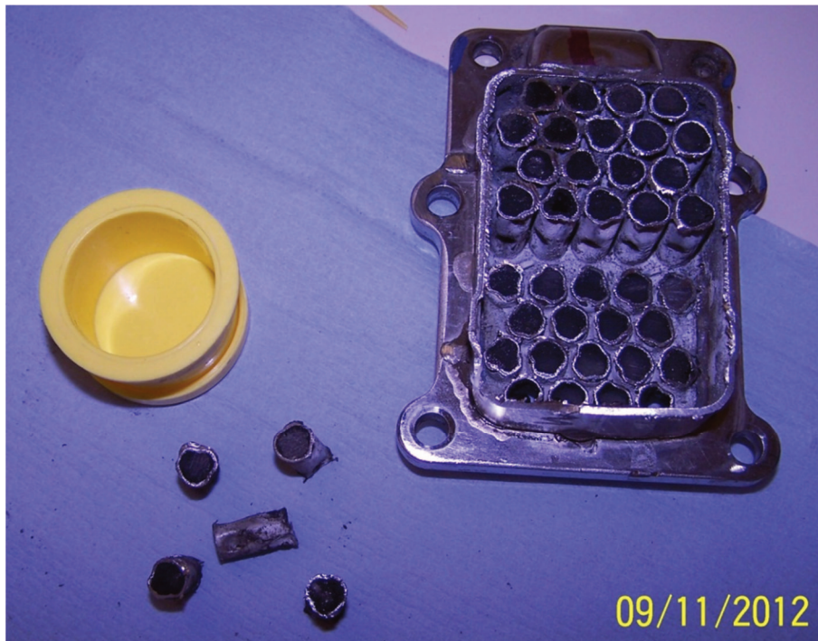
Abbildung 10-1: Abgeschnittener Teil eines AGR-Kühler-Moduls und fünf herauspräparierte Kühlerrohre, die mit Epoxid-Harz gefüllt sind.
