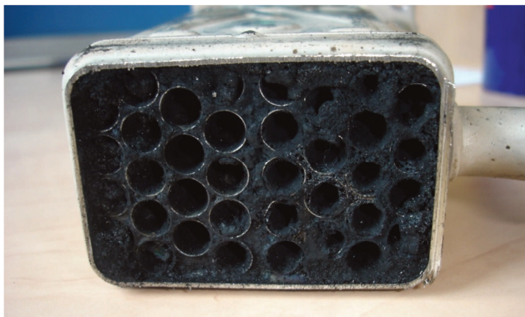
Abbildung 7-1: Metallografischer Schliff vor der 180°-Umlenkung eines AGR-Kühlers aus einem PKW Turbo-Dieselmotor (Probennummer AGR 1).
