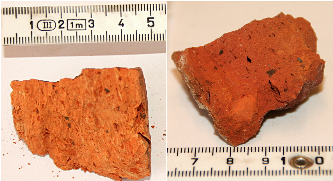
Abb. 4.1: Spuren der Rohstoffaufbereitung Fotos: Seidel.
