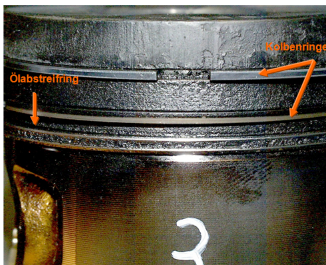
Abbildung 2.2-17 Stark mit Motorölkohle behafteter Kolben des zerlegten Motors
