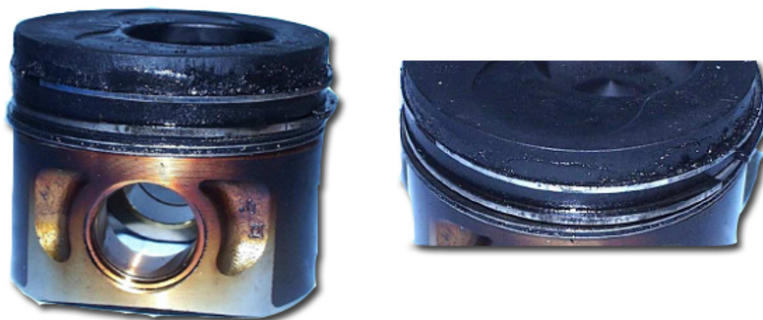
Abbildung 3.4-2 Kolben aus Fzg20 mit starker Ablagerung in den Ringbereichen aller Kolben
