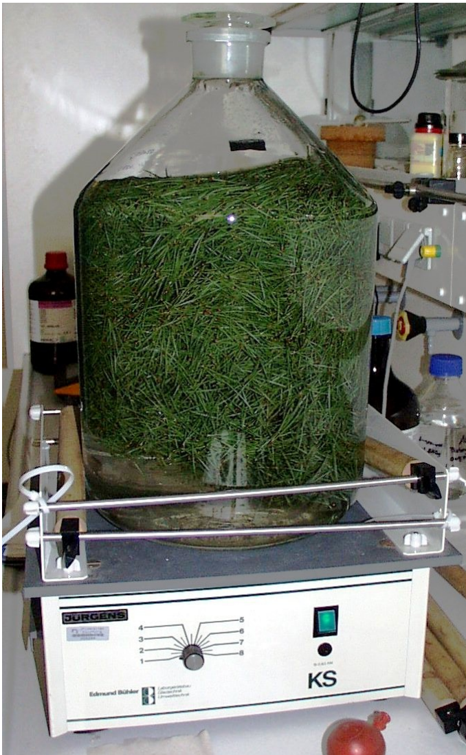
Abbildung 8: Verteilungsversuch mit intakten Nadeln, serieller Versuchsansatz
