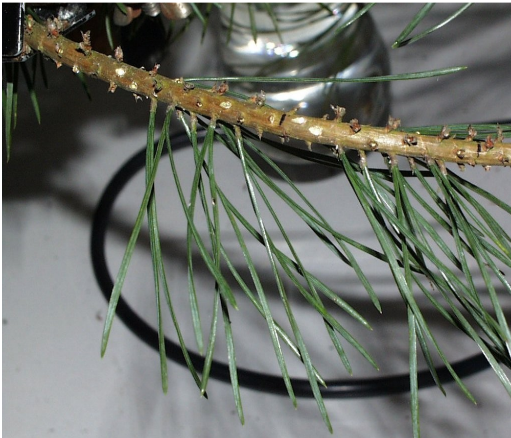
Abbildung 10: mit Isoproturon benetzte Kiefernadeln vor der Desorption in die herbizidfreie Pufferlösung
