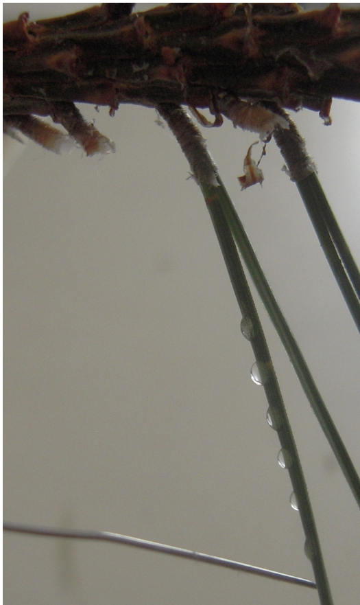
Abbildung 11: Benetzen der Nadeln mit einer 10 µl Mikroliterspritze
