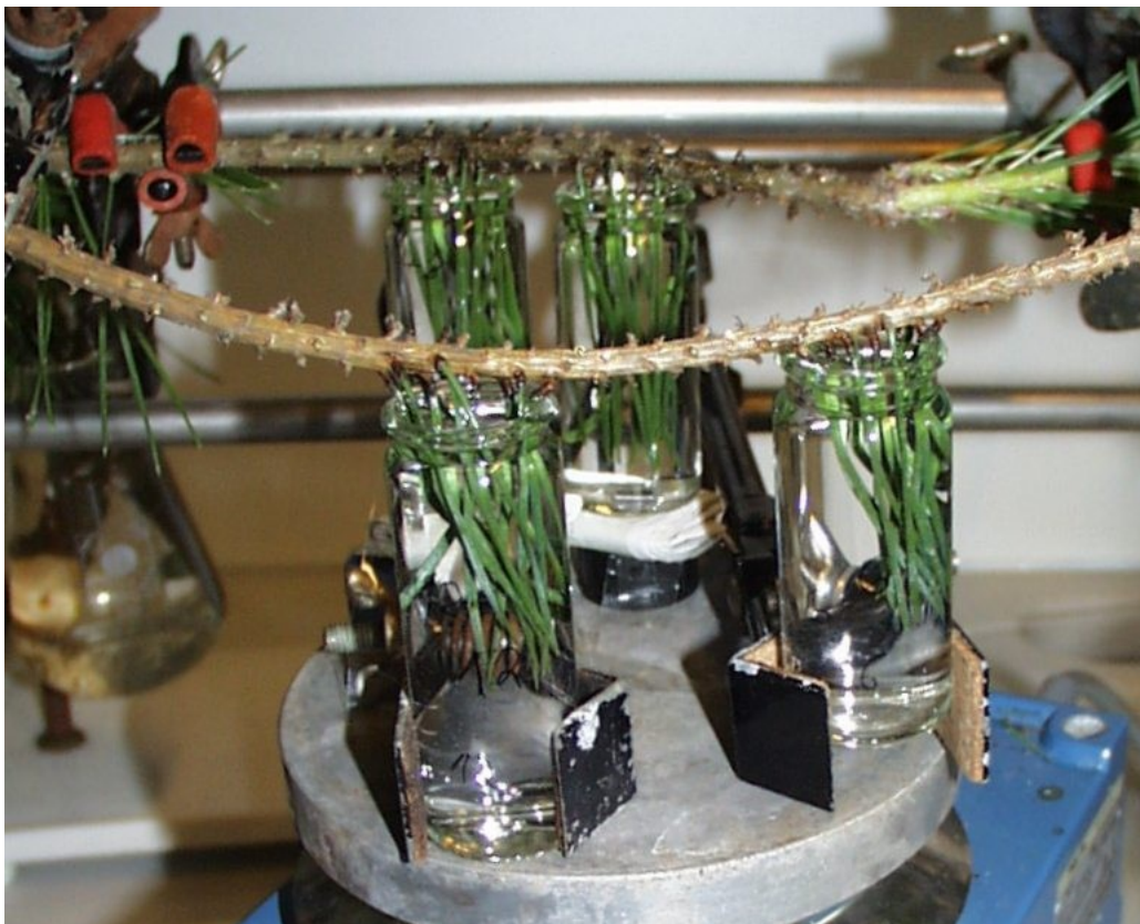
Abbildung 12: Kiefernadeln, zur Desorption eingetaucht in herbizidfreie Pufferlösung
