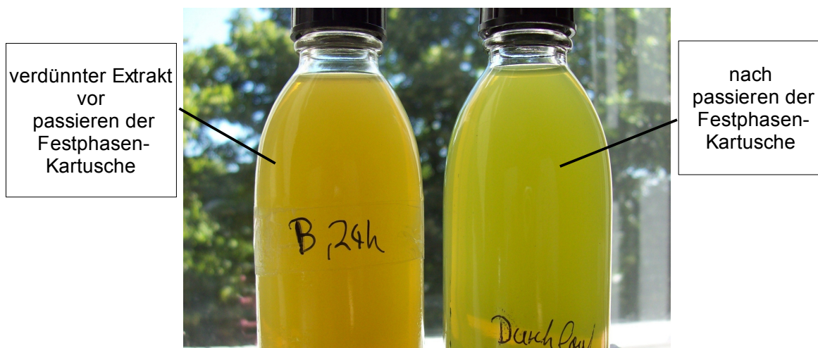
Abbildung 21: Zwei mit Reinstwasser verdünnte Extrakte aus Kiefernnadeln, vor und nach passieren einer LiChrolut EN 200 mg Kartusche
