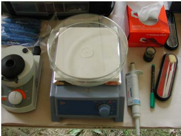
Abb. 3-3: Probenpräparation für die TXRF unter Feldbedingungen (MAGES et al. 2004b)
