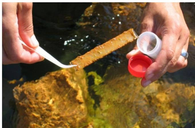
Abb. 3-10: Überführung der Aufwuchsträger für den Transport in Polycarbonatröhrchen
