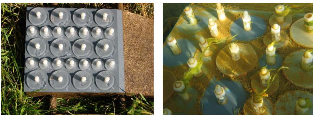
Abb. 3-8: Biofilmwachstum auf runden Polycarbonat-Trägern, links vor dem Auslegen und rechts nach entsprechender Aufwuchszeit (MAGES et al. 2006)
