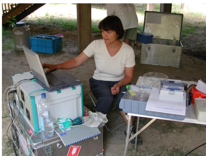
Abb. 3-32: Feldeinsatz des portablen TXRF-Spektrometers PICOFOX™ (Foto: K. Rahn, UFZ)
