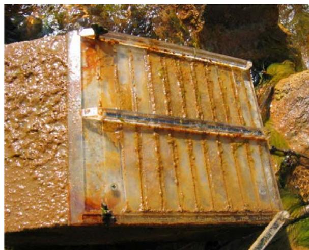
Abb. 3-7: Biofilmwachstum auf langen Polycarbonat-Trägern (MAGES et al. 2006)
