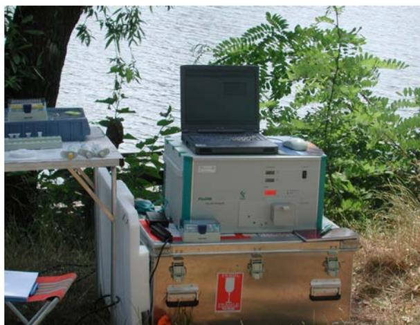
Abb. 3-2: Feldaufbau des portablen TXRF-Spektrometers mit entsprechendem Equipment (MAGES et al. 2004b)
