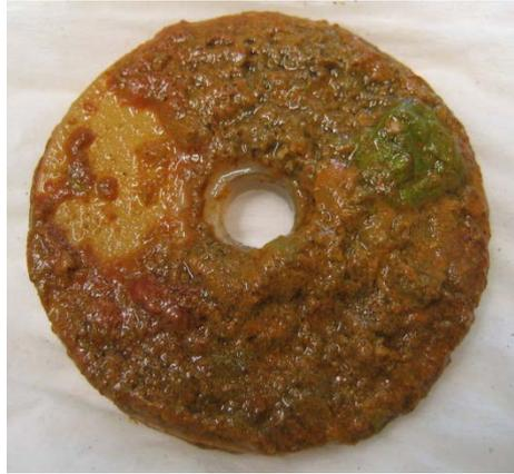
Abb. 3-16: Frischbiofilm mit sichtbar stark ausgeprägter EPS
