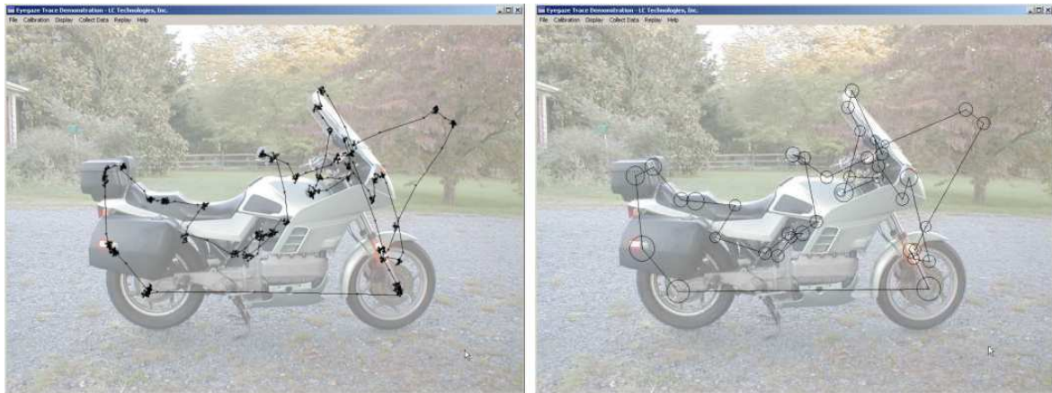
Abb. 2 - 22: Aufzeichnung der Rohdaten (links) und Ableitung eines Scanpath (rechts), Quelle: Metrovision, F-Pérenchies
