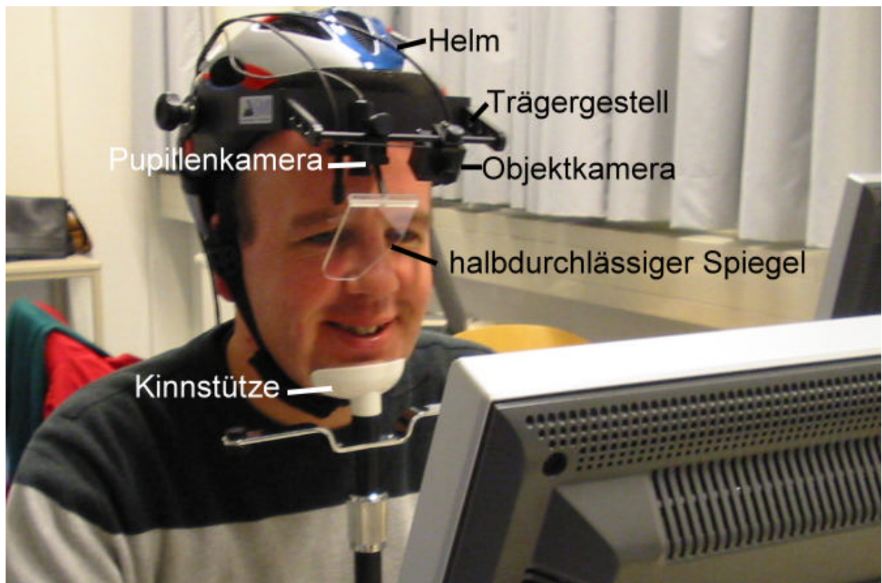
Abb. C - 3: Eye-Tracking-System des Herstellers SMI im Einsatz (eigene Darstellung)
