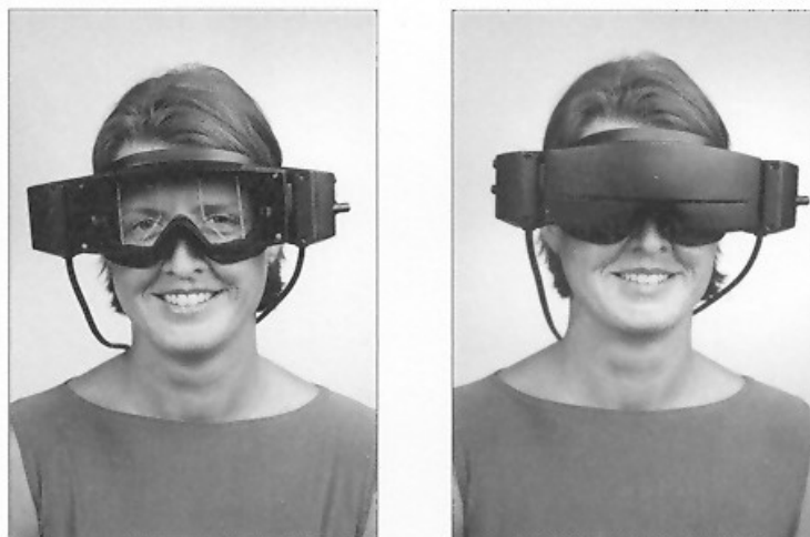
Abb. 2 - 18: Video-Okulographie-Maske, Quelle: Interacoustics A/S, DK-Assens
