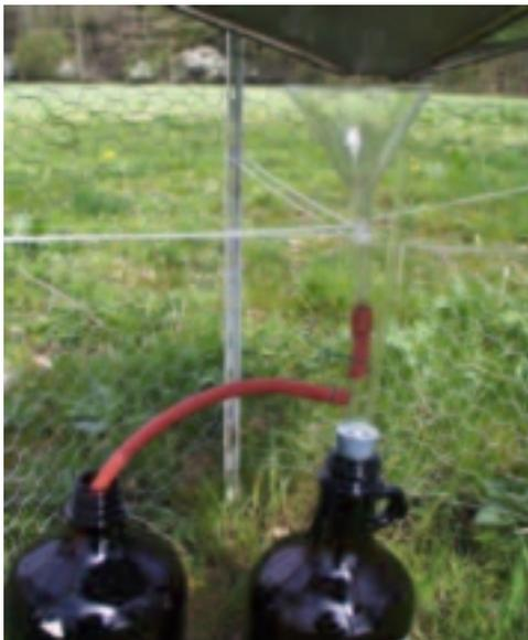
**Abbildung 22:** Überlaufschutz an Regensammler R-WR1
