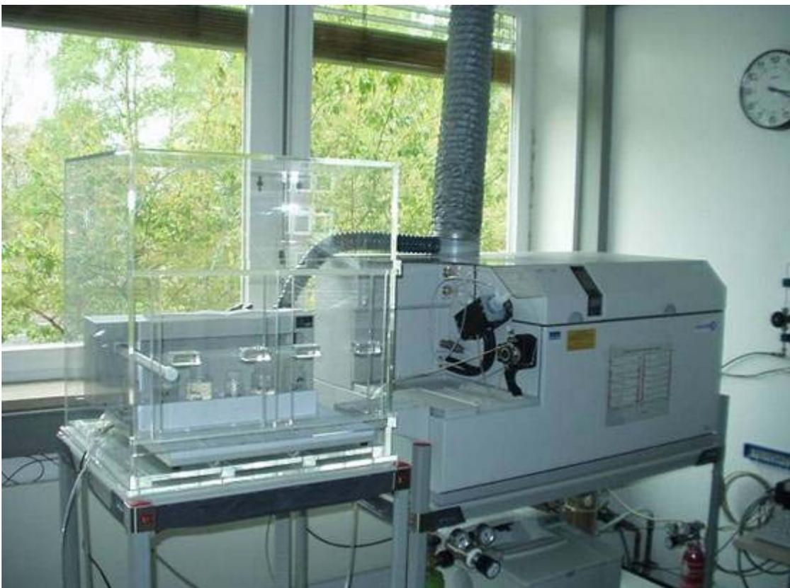
Abbildung 25: ICP-QMS mit gekapseltem Probenwechsler
