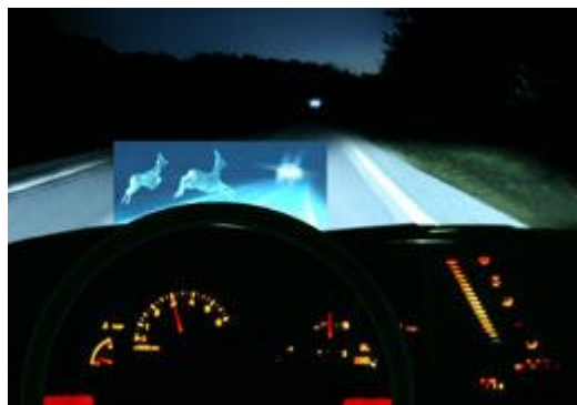
Abbildung 3.10 Das Head-up Display zeigt auf der Windschutzscheibe mögliche Gefahren auf der Fahrbahn an [BMBF 2007]
