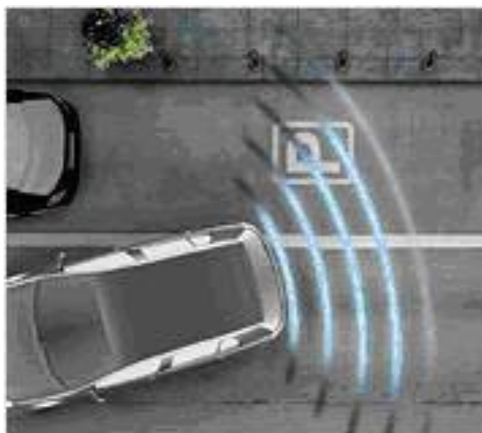
Abbildung 4.6 Einparkhilfe mit Ultraschallsensor [Volkswagen 2007b]
