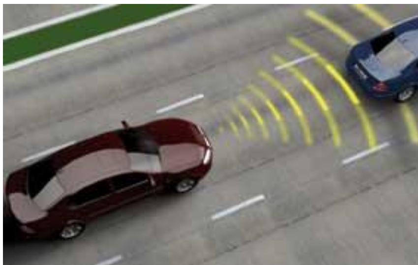
Abbildung 4.7 Radarsensor zur Abstandsregelung [Mobil und Sicher 2007]
