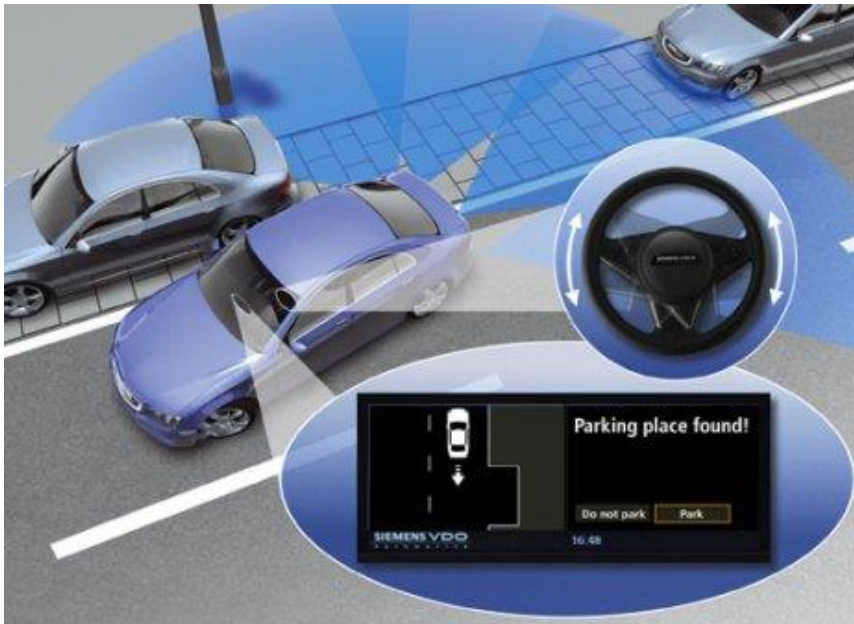
Abbildung 3.7 Einparkassistent mit Sensorausleuchtungsgebiete [Infohamster 2005]
