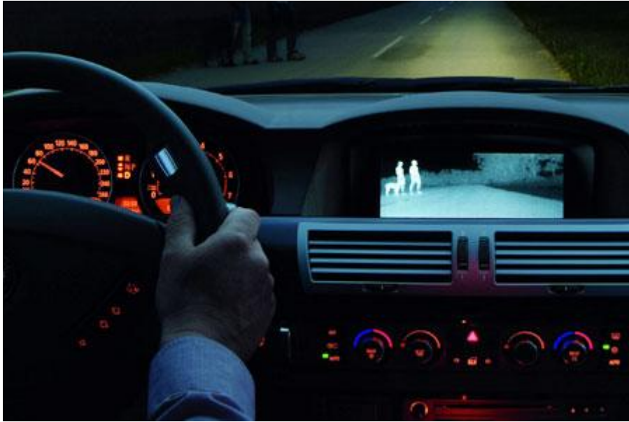
Abbildung 3.9 Der Monitor zeigt das Geschehen vor dem Fahrzeug mittels Wärmebildkamera an [ADAC 2007]
