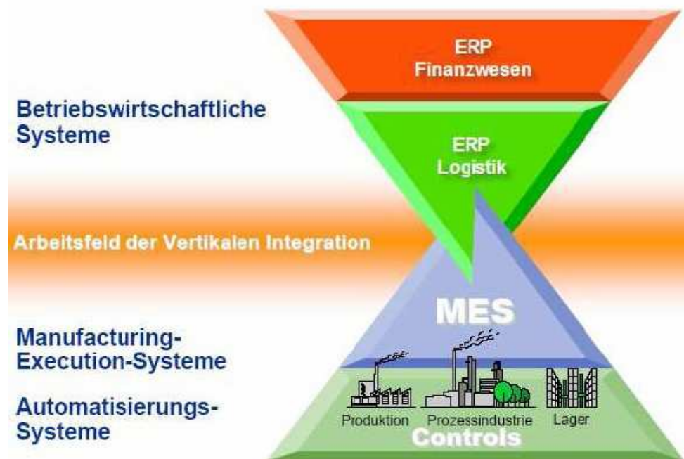
Abbildung 3: Simatic Pyramide – Vertikale Integration
