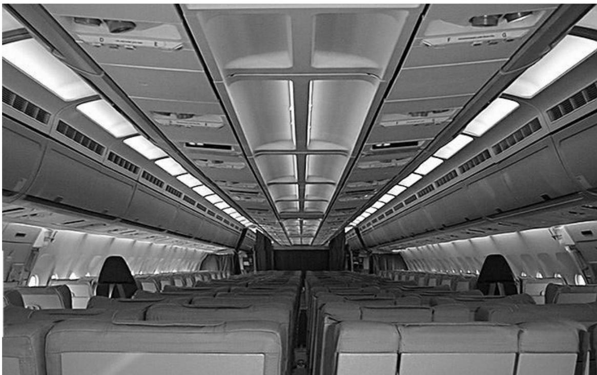
Abb. 3-1 Versorgungskanal einer A300-600 [13]
